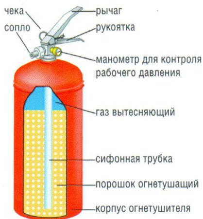
Устройство, заряженное огнетушащим порошком и закачанное газом (воздухом, азотом или углекислым газом). Порошковые огнетушители используют для тушения следующих классов пожаров:
