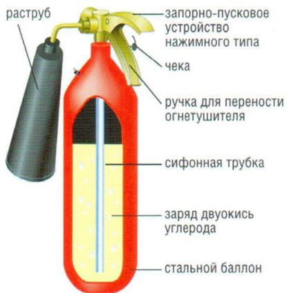
Устройство с зарядом двуокиси углерода (CO<sub>2</sub>) сжиженной, это позволяет снижать температуру и вытеснять кислород в месте возгорания. Углекислотные огнетушители используют для тушения следующих классов пожаров:
